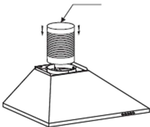
3. Извлеките вытяжку из коробки и аккуратно поставьте на горизонтальный рабочий стол. Установите выходную трубу 150 мм к выходному патрубку и убедитесь, что она плотно присоединена.
