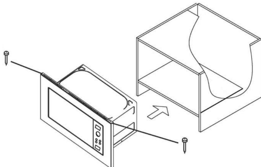
Откройте дверцу микроволновой печи, вставьте винт (3) и вкрутите его в полку шкафа. Закройте шляпку винта колпачком (2). Установка завершена.
