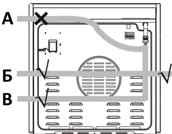
Если для подключения используется гибкий шланг, то его нельзя устанавливать в положение «A».
