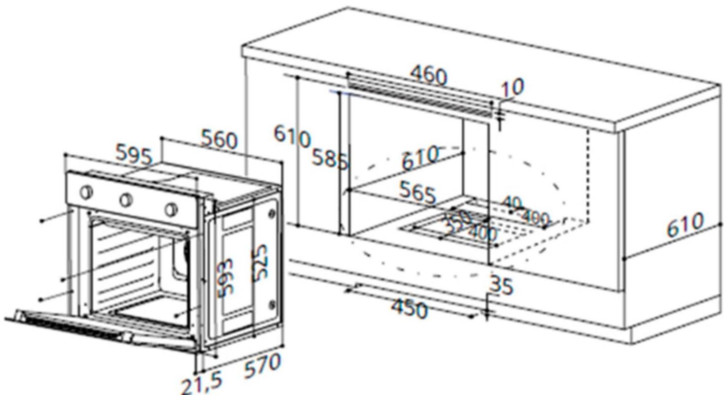
\*Рекомендуемые размеры выреза в дне шкафа для обеспечения вентиляции составляют 400x350 мм.
