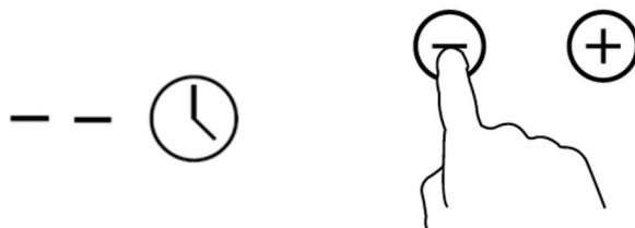
3. Установите значение таймера с помощью кнопок «-» или «+». Индикатор таймера начнёт мигать, на дисплее таймера будет отображаться установленное время. Через 20 секунд индикаторы выключатся, но таймер продолжит работу.
