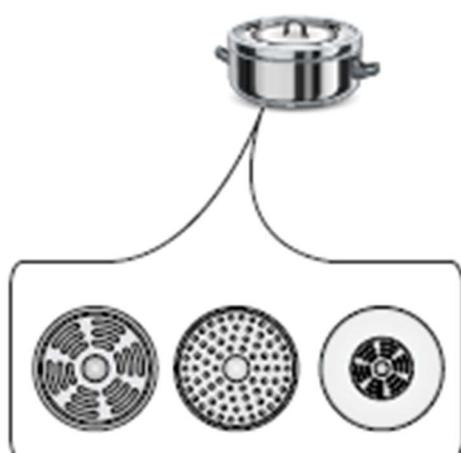
на индукцию, нержавеющая сталь (хромистая сталь). Индукционная панель не будет работать с посудой из обычной нержавеющей стали, стекла, керамики, меди и алюминия, если дно посуды не выполнено из ферро магнитного материала.
