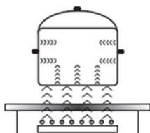
Тепло образуется посредством магнитной индукционной катушки, которая создает магнитное поле. Под ее действием посуда нагревается и тепло от кухонной посуды передаётся пищевому продукту.
